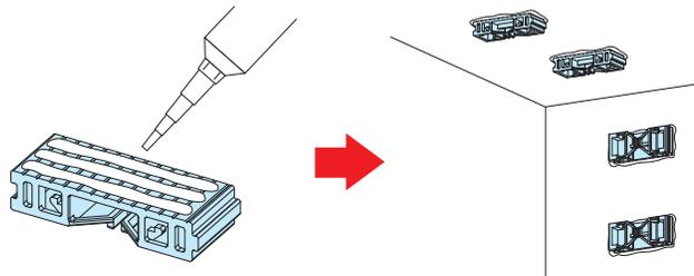
**2** 養生後、十分接着している事を確認してから配管をし、同時にサドルを押し当てるように固定します。「カチッ」という音が固定の目安です。参考養生時間：4時間以上（周囲温度23℃）
