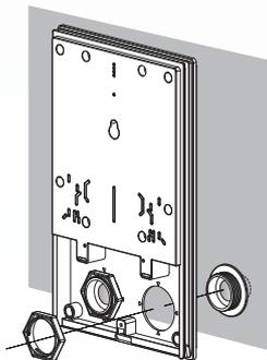
外壁面に貫通材(おねじ)を差し込み、周囲をコーキング。基板取付け後、貫通材(めねじ)を締付けます。
