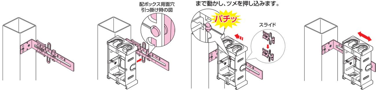
●材質：金具部 / 亜鉛めっき鋼板、スライド部 / 硬質塩化ビニル
