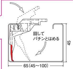
取付け位置に合わせ、先端の薄い部分(赤色部分)を手前に引くとパチンと留まります。
