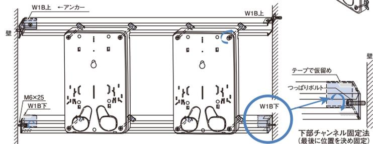
5 下部用金具のねじを回し、壁に固定する。
