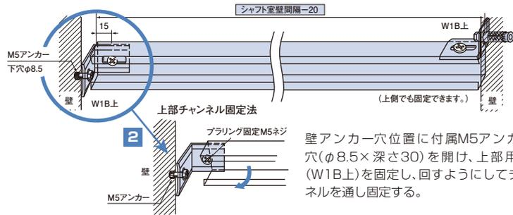
壁アンカー穴位置に付属M5アンカー用穴(φ8.5×深さ30)を開け、上部用金具(W1B上)を固定し、回すようにしてチャンネルを通し固定する。
