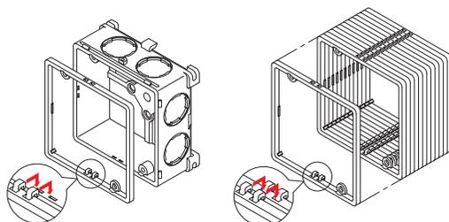
※ご注意: 当社ワンタッチ式塗代カバー類にボックス継棒を使用する場合は全てねじで固定してください。
