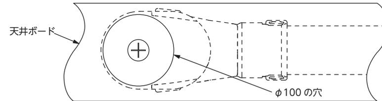
5. 取出口を天井ボードに取付け、ねじで固定してください。
