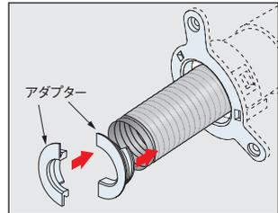
ガスフレキ管配管後、両端にアダプターを取付けて完了。
