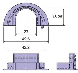
●材質：耐衝撃性硬質塩化ビニル
