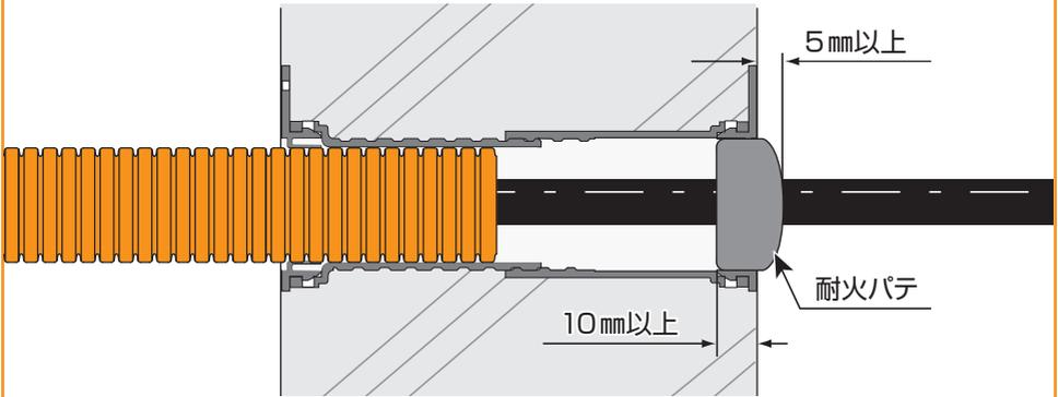
**P4** ステンレス鋼フレキシブル管(ガスフレキ管)や被覆付ポリエチレン被覆金属管(被覆金属管)も配管可能です。
