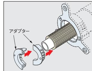
被覆金属管配管後、両端にアダプターを取付けて完了。
