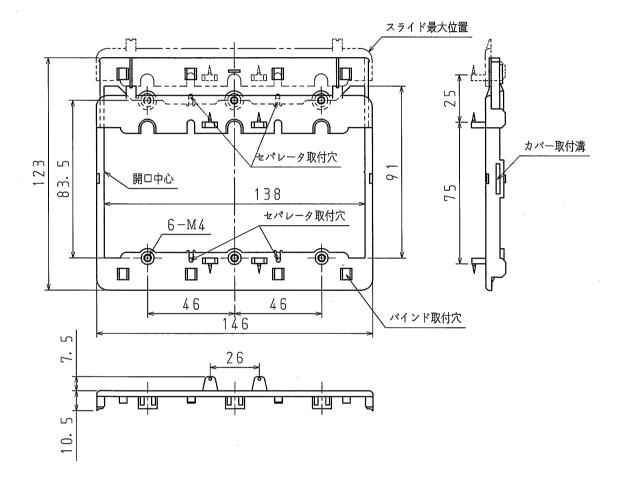
\*M4×30十字穴付皿小ネジ6本付属 \*施工時推奨開口寸法:90<sup>+5</sup>×138<sup>+5</sup>
