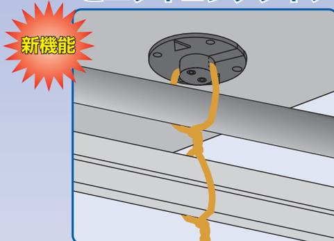
上下を用いて、2系統の配線・配管が可能です。大口径の管も支持できます。
